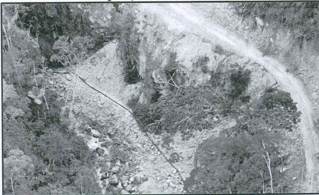
Foto N°6: Sector con fallas repetitivas en la conducción por deslizamientos – Sistema Juninguillo. (290395.861E, 9334215.492N)
