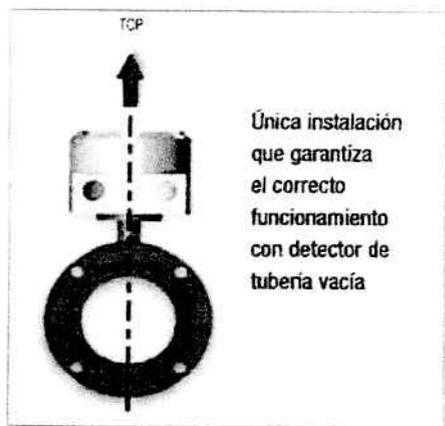
Única instalación que garantiza el correcto funcionamiento con detector de tubería vacía
